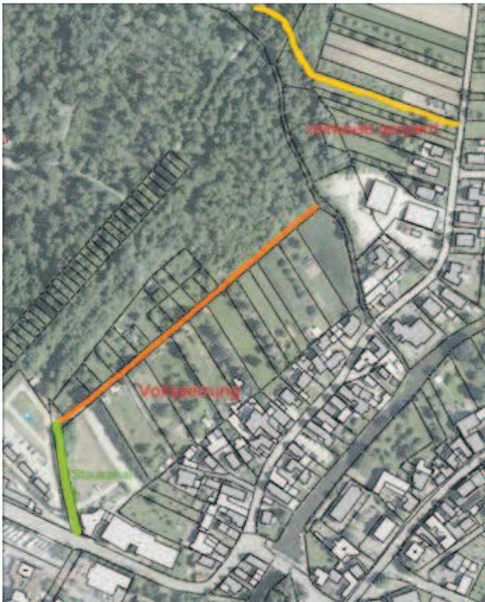
Der Neubau des Staukanals (grüner Abschnitt) wird via bohrlosem Vortrieb durchgeführt. Das Rammgerät muss aus Zeit- und Wirtschaftlichkeitsgründen von Mo.-So. von
